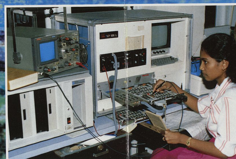
Vérification d'une plaquette de circuit imprimé défectueuse à l'aide du TLP 128L au Centre de réparation (Telecommunications Headquarters) de Colombo Checking a faulty printed circuit board using TLP 128L at the Repair Centre (Telecommunications Headquarters), Colombo Comprobación de una placa de circuito impreso defectuoso utilizando el TLP 128L en el Centro de Reparaciones (Telecommunications Headquarters) en Colombo
