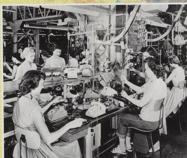
Fabrication: des ouvrières assemblent et testent des appareils téléphoniques (SPI France) Manufacture: workers assemble and test telephone sets (SPI France) Fabricación: operarias de una cadena de montaje y prueba de aparatos telefónicos (SPI France)
